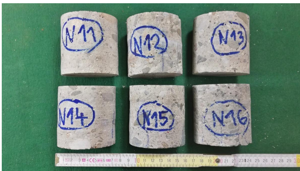
Obr. 6: Zkušební tělesa N 11 až N 16 z desky nad 1. NP se štíhlostním poměrem 1:1.
