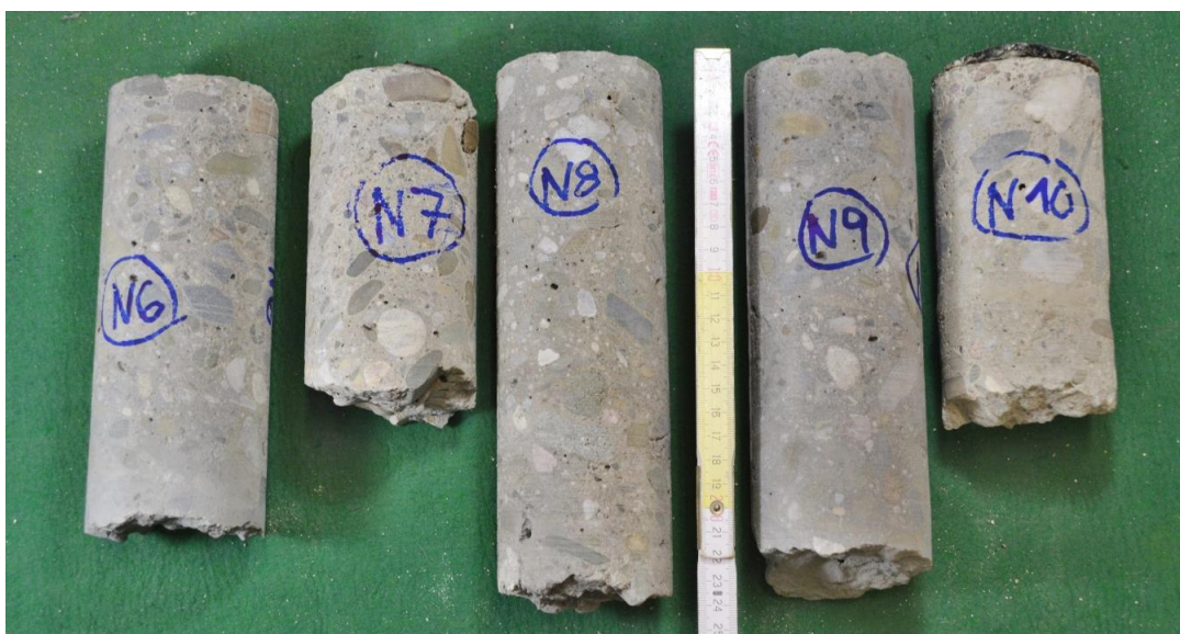
Obr. 2: Zkušební vzorky N 6 až N 10 odebrané ze stropní desky nad 1. PP krytu CO.
