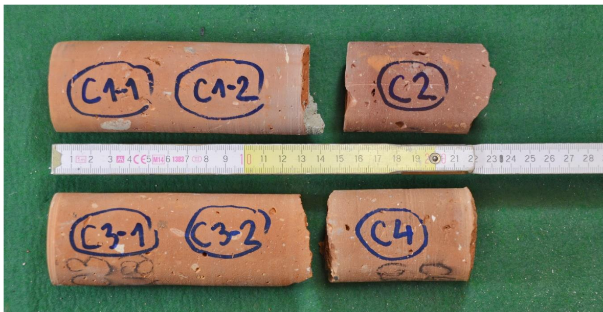
Obr. 11: Zkušební vzorky cihel odebrané jádrovým vrtákem o průměru \varnothing 50 mm ze stěn v 1. NP objektu (C 1, C 2) a 2. NP objektu (C 3, C 4).
