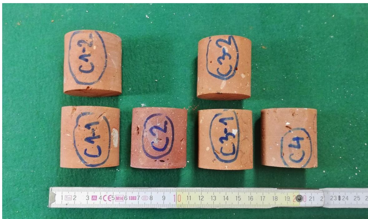
Obr. 12: Zkušební tělesa ve tvaru válce 1:1 vyrobená ze vzorků C 1 až C 4.
