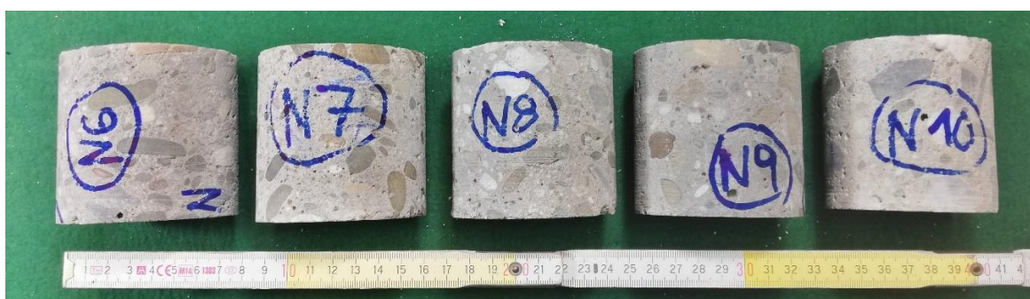
Obr. 5: Zkušební tělesa N 6 až N 10 z desky nad 1. PP se štíhlostním poměrem 1:1.
