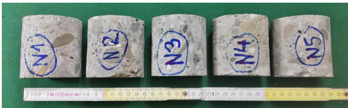
Obr. 4: Zkušební tělesa N 1 až N 5 ze stěny krytu CO se štíhlostním poměrem 1:1.
